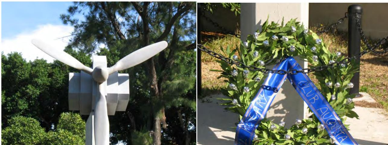
Le linee massime di ingombro del monumento corrispondono a quelle reali della parte frontale del motore Fiat A-74 SC.38 che, in due esemplari, era montato sugli idrovolanti tipo RS.14; anche l'elica tripala ha le dimensioni analoghe all'originale.
